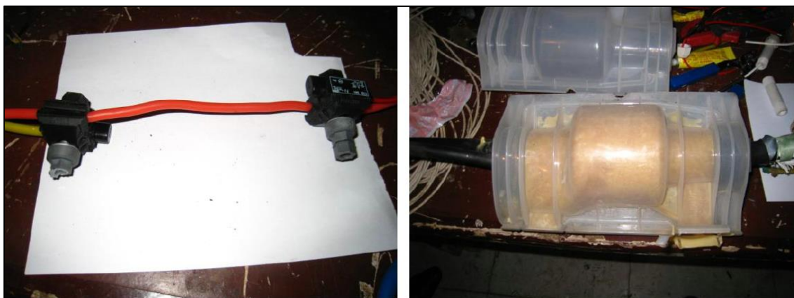
图 5.7 电缆取电接线密封盒
