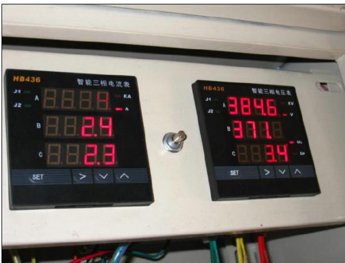
图 5.8 改进后的温控箱（电压可调）
